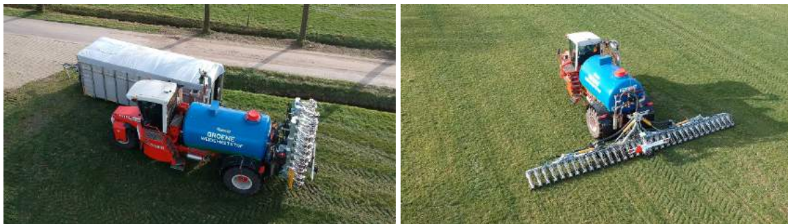
Illustratie 3 Toedieningstechniek voor de bemesting van de Groene Weide Meststof. Dit type heeft een werkbreedte van 12 m. Een werkbreedte van 18 m is eveneens mogelijk.
