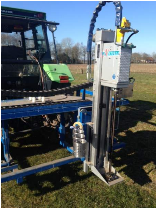
Illustratie 2 Bemonstering van de bodemlagen 0-30 cm, 30-60 cm en 60-90 cm werd uitgevoerd met de motorboor van WUR Unifarm.
